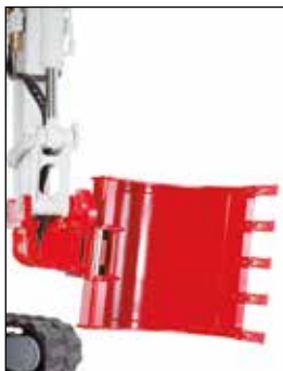
PowerTilt con enganche rápido hidráulico, cazo montado al revés
