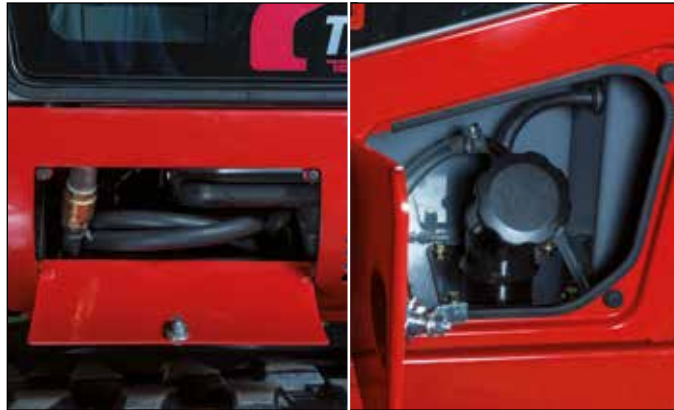
Tapa abatible adicional para un acceso óptimo a la bomba de repostar y la tapa del depósito de gasoil.
