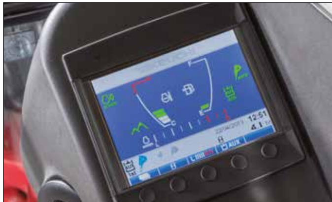
Display con unidades de control acústicos y visuales. Modo ECO para aumentar la rentabilidad y disminuir el consumo de gasoil.
